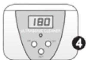
Нажмите кнопку SET, чтобы выбрать рабочий режим. Автоматически на дисплее отобразится цифра 180. Это наиболее используемый режим. Каждый раз, нажимая кнопку SET, вы выбираете один из доступных 5 режимов: 180 с - 280 с - 380 с - 480 с - 90с. Данные цифры будут отображаться на экране. Пользователи могут выбирать рабочий режим, в соответствии с количеством предметов.
